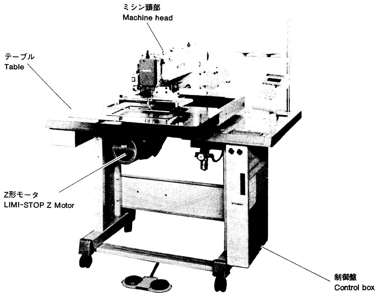
注1：モータ部分は三菱リミストップZクラッチ：モータの部品カタログ(P-007)を参照ください。
